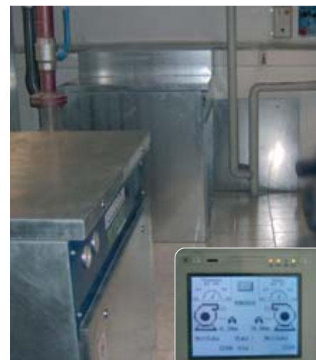
•Przemysł papierniczy: Agregaty wytwarzające nadciśnienie oraz podciśnienie ROBOX evolution ( P ) / agregat wyposażony w dmuchałkę z dodatkowym wlotem powietrza (DV)
