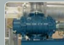
•Inżynieria: napowietrzanie emulsji olejowej oraz oczyszczanie płynów przy pomocy systemu termokompresji. Dmuchała wirnikowa (RBS).
