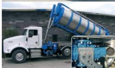
•Jednostki mobilne do zasysania pyłów lubli płynów. Dmuchała do wytwarzania próżni: TRB-DV.
